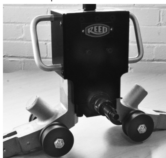
2. Apriete el Husillo largo sobre la unidad del motor 2. Serrez l'arbre sur le bloc moteur
